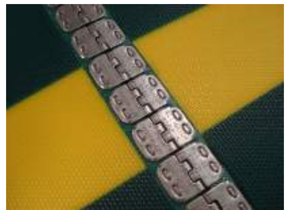
Détail de l'Aster 22AF-Ski jonctionnée avec agrafe.
